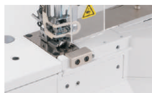
Cama de cilindro; fácil de alimentar
