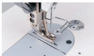
Para trabajo muy pesado prensatelas doble
