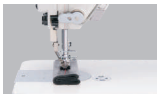
Para trabajo muy pesado prensatelas doble
