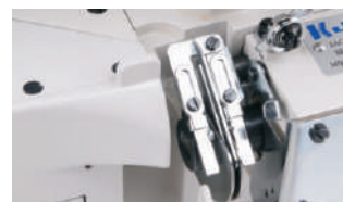
Cámara de hilos de fácil acceso (movible)
